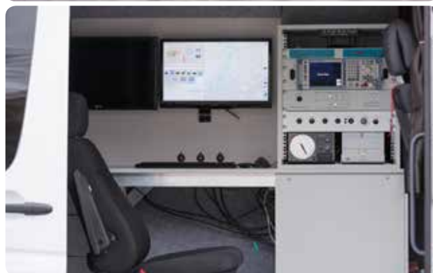
Gépjárműbe telepített mérőberendezések – az NMHH egyik mérőautója és annak belseje
