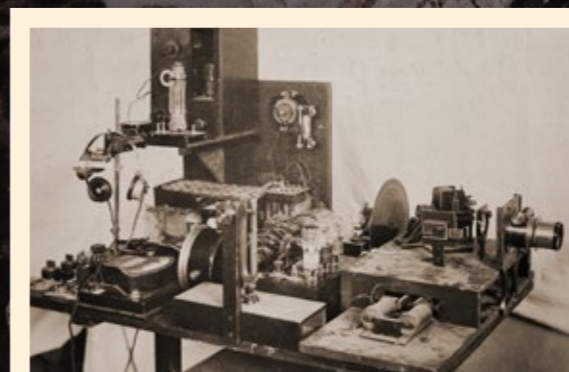
A forgótárcsás technológiájú Telehor készülék lelke
